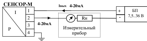
1) Схема подключения с выходным сигналом 4-20мА.
