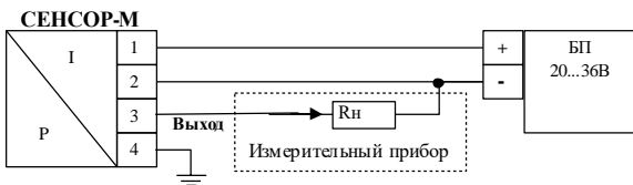
2) Схема подключения с выходным сигналом 0-5 мА, 0-10 В, 0,4-2
